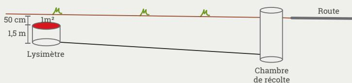
Les lysimètres mis en place sont constitués d'un cylindre en inox de 1 m<sup>2</sup> de section pour une hauteur de 1,5 m. Ils ont été placés à 50 cm sous la surface pour faciliter le travail du sol, le plancher drainant étant localisé à 2 m de profondeur. Ce dernier évacue les eaux du lysimètre vers un bidon de récolte placé dans une chambre de visite construite en bordure de champ.
