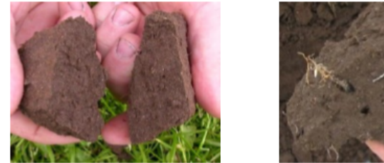
Figure 2 : Exemples de mottes fermées (Rachel Muylaert Locks Guimarães, 2011): à gauche très peu de racines et faces pratiquement planes après rupture de la motte ; à droite : cas typique de racine traversant une motte fermée via une galerie de lombric
