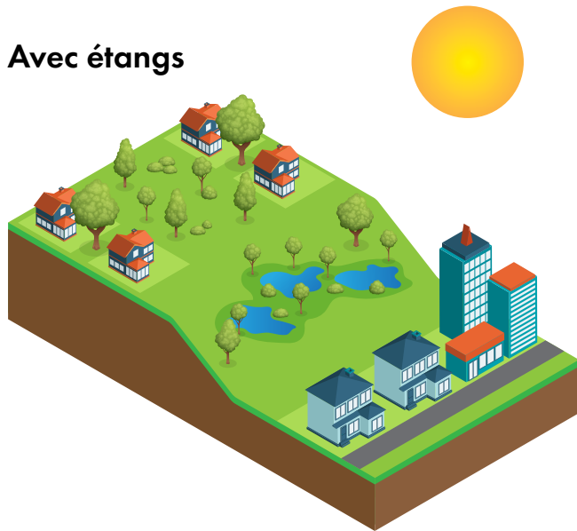
Fig. 10 - Illustration simplifiée du bénéfice apporté par un petit paysages d'étangs (trois étangs de 500 m 2 ) situé dans le bassin versant d'une zone urbaine. La figure de gauche présente la situation sans le paysage d'étang, avant (en haut) et après (en bas) une tempête. La figure de droite présente la même situation, mais avec l'avantage de l'aménagement de trois bassins de 300 m 2 avec une zone de rabattement capable de stocker 144 m 3 d'eau de pluie, réduisant ainsi le risque d'inondation.
